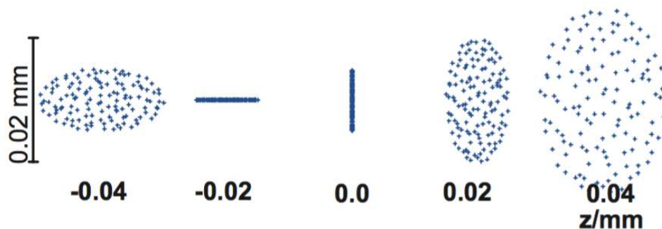
Abbildung 3.14: Astigmatismus-Strahlprofile an verschiedenen Positionen um die sagittal-fokussierte Ebene. Das Profil in der Mitte zeigt die Intensitätsverteilung in der sagittal-fokussierten Ebene. In meridialer Richtung ist der Strahl unfokussiert. An Position z = -0,02 mm ist der Strahl meridial maximal fokussiert. Abbildung entnommen aus [35].
