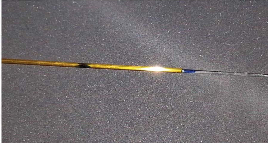
Abbildung 21: Platzierung der Faser im Polyamidröhrchen: durch die zweite Markierung der Faser ist sicher gestellt, dass die richtige Position eingenommen werden kann, auch wenn die erste durch den Klebstoff ausgelöscht werden sollte.
