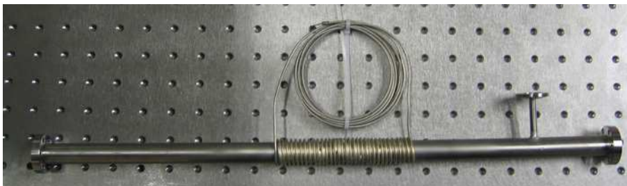
Abbildung A.1: Stahlrohr mit Heizleiter und Anschweissflanschen
